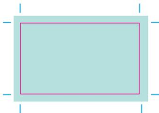
Les **traites de coupe** représentent l'endroit où la lame va s'enfoncer dans le papier pour le couper. Ils sont imprimés avec le document et indiquent à l'imprimeur **l'endroit exact où il doit couper**.
